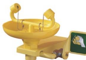
Vaschetta in resina sintetica (ABS) anticorrosiva. Tubazioni in acciaio zincato per una lunga durata anche in atmosfere molto aggressive. Valvola di comando a barra antipánico. Erogatori a grande portata di acqua nebulizzata. Ugelli in ottone nichelato e cromato, posizionati ergonomicamente. Come richiesto dalla norma UNI 9608, la valvola a barra, una volta azionata rimane aperta, lasciando entrambe le mani libere.
