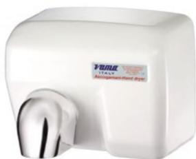
Asciugamani anti vandalo, potenza 2400 W con scocca in acciaio e bocchettone girevole a 360°, funzionamento a pulsante o sensore di rilevamento elettronico a raggi infrarossi. Temporizzazione regolabile da 25 a 180 secondi. Doppio termostato per la massima sicurezza, sia sulla resistenza che sul motore. Disponibile in acciaio satinato e nella versione a smalto colore bianco.
